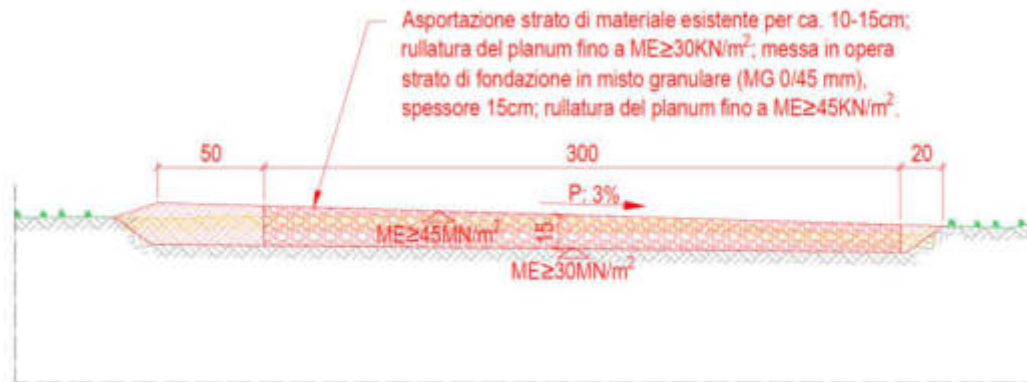
Fig. 9: stabilizzazione del corpo stradale con spessore medio di 15 cm.
