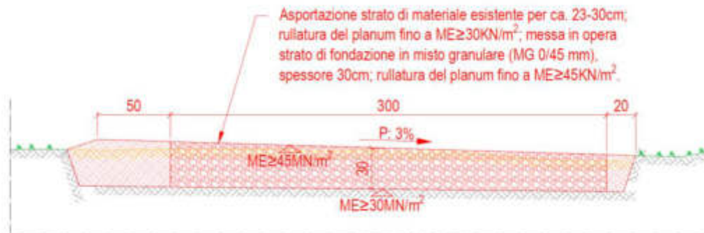
Fig. 10: stabilizzazione del corpo stradale con spessore medio di 30 cm.
