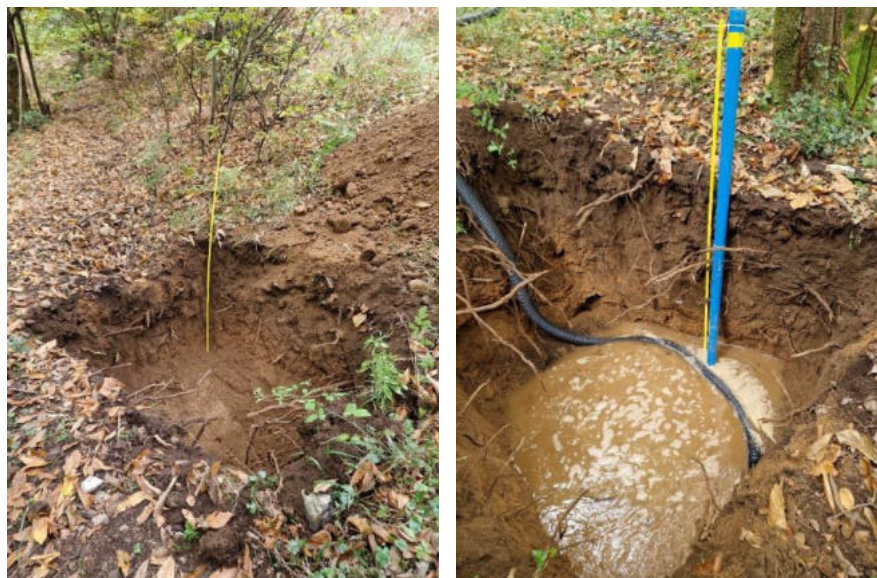
Figura 19: Prova di infiltrazione in ZONA 1, estratta dalla perizia idrogeologica dei nov.2024.
